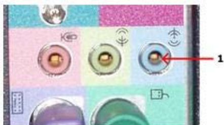
サウンドカードとミニジャックコネクタ（1）のラインが統合されたコンピューターの背面ペイン
