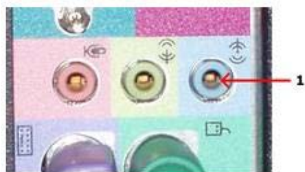
サウンドカードとミニジャックコネクタ（1）のラインが統合されたコンピューターの背面ペイン
