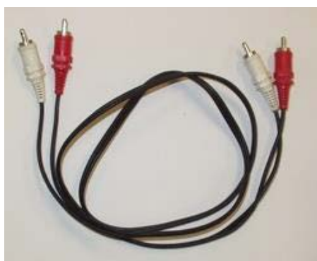
両端に RCA コネクタが付いた接続ケーブル
